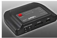
Abbildung 5.14: Rückansicht inDart-One mit MON08- und BDM-Schnittstelle
