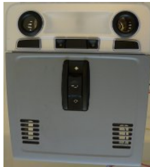
Abbildung 4.3: Dachmodul aus dem BMW X5
