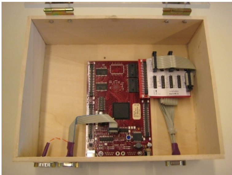
Abbildung A.3: Pedalboard in seiner Kiste mit Anschluss für Pedale
