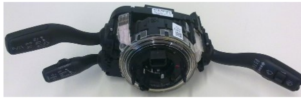
Abbildung 4.2: Lenksäulenmodul aus dem Audi A8
