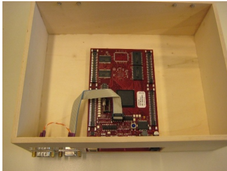
Abbildung A.4: TC1796 mit Virtual Machine in seiner Kiste
