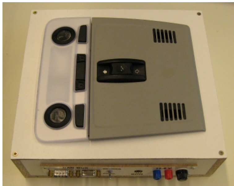
Abbildung A.5: Dachmodul in seiner Kiste mit Schalter für Betriebsmodus
