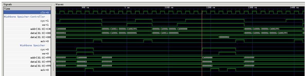
Abbildung 8.4: Waveform der Ausführung einer Test and Set Operation
