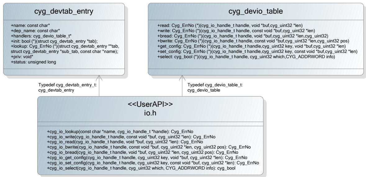
Abbildung 5.3: Klassendiagramm der Gerätetreibereinträge cyg_devtab_entry und cyg_devio_table und ihre Verwendung in der User API .
