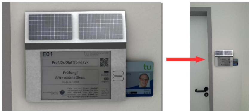
Abbildung 2.4.: Vision des Solar Doorplates (aus [27]), welches Auskunft über die Raumbelugung oder aktuelle Veranstaltungen geben soll.
