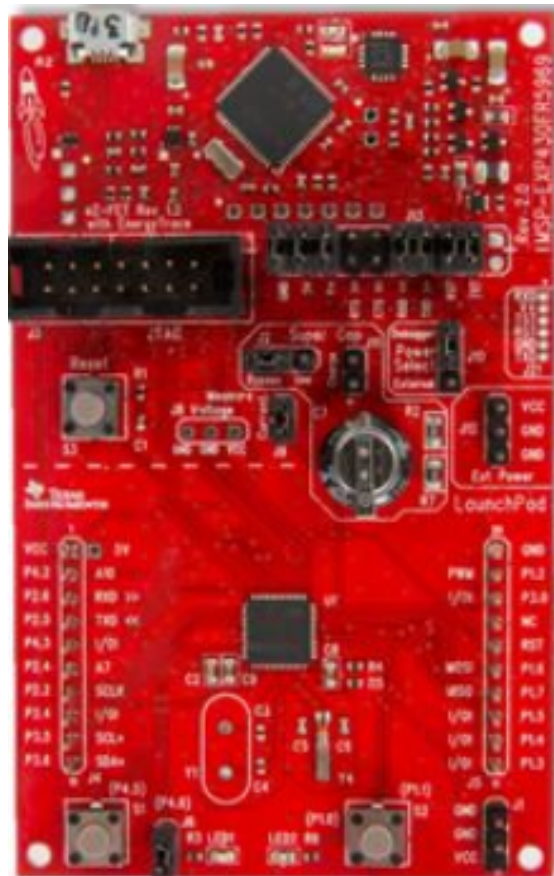
Abbildung 2.27.: Das MSP430FR5969 LaunchPad. Zu sehen ist unten zum einen die Hauptplatine mit dem MSP430FR5969 Mikrocontroller und oben die integrierte Programmierschaltung zum Aufspielen der Firmware und Debuggen [38].
