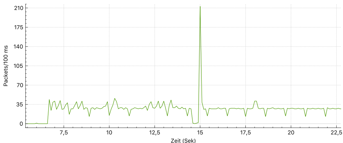
Abbildung 5.10: Fehlertoleranz durch sekundären SDN Controller, beim Ausfall des primären.
