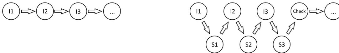
**Abbildung 2.1:** Ablauf von Instruktionen ohne EDDI (links abgebildet) und mit EDDI (rechts abgebildet) [3]
